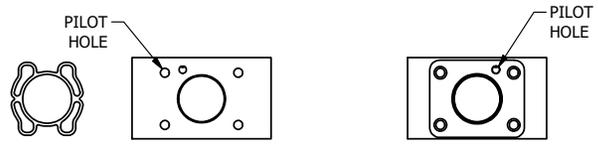
POSITION GASKET ON END OF VALVE BETWEEN BODY OR PEC3-18 AND SOLENOID OPERATOR BOTH SIDES (SIDE 'B' SHOWN)
