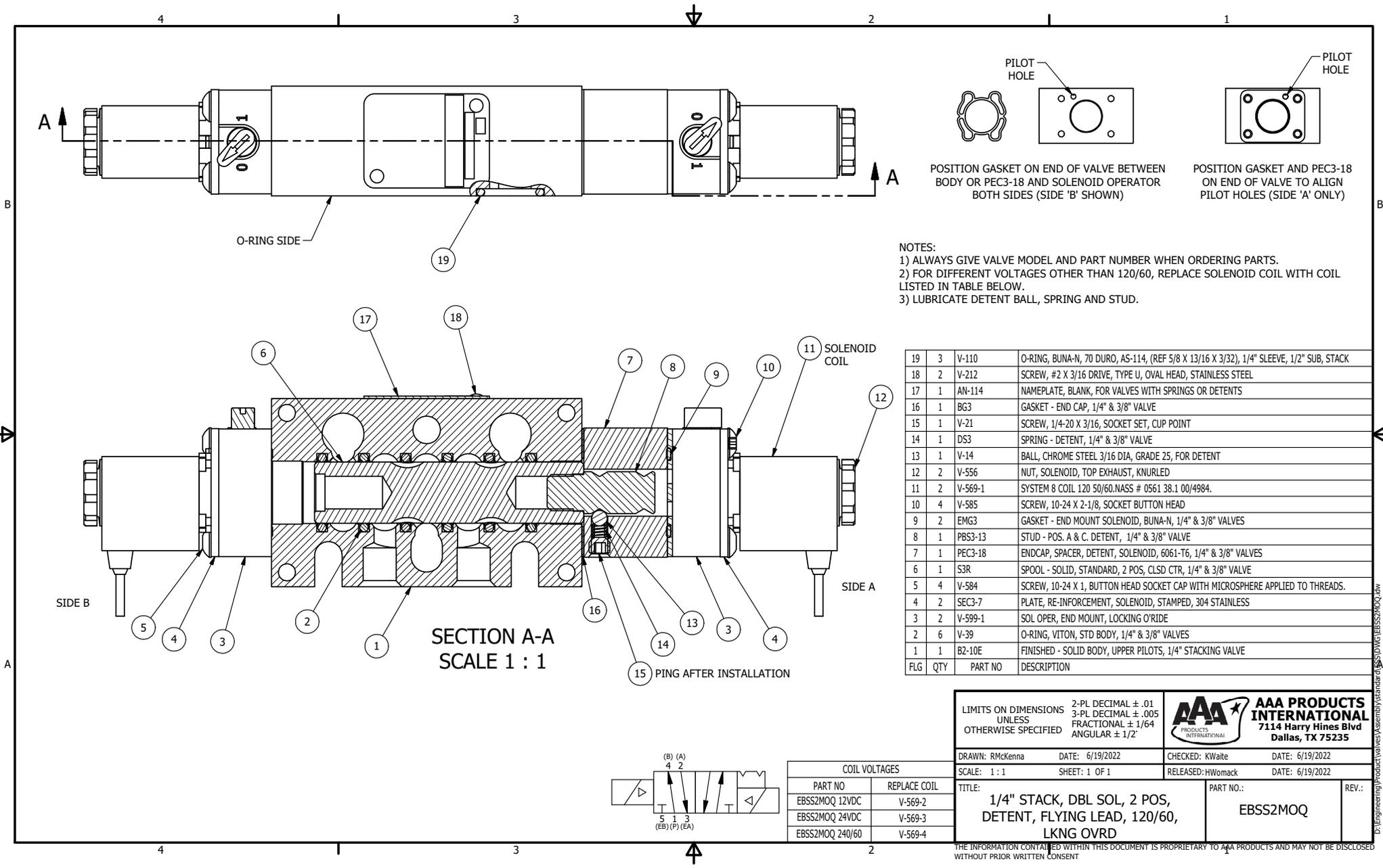
POSITION GASKET ON END OF VALVE BETWEEN BODY OR PEC3-18 AND SOLENOID OPERATOR BOTH SIDES (SIDE 'B' SHOWN)
