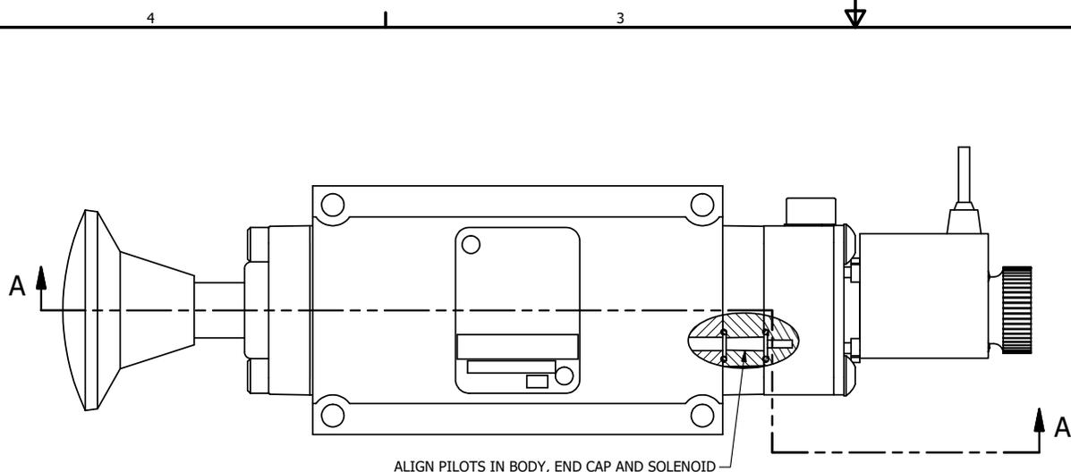
ALIGN PILOTS IN BODY, END CAP AND SOLENOID
