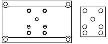
ALIGN HOLES IN GASKET AS SHOWN.
