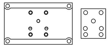
ALIGN HOLES IN GASKET AS SHOWN.
