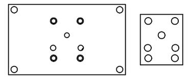
ALIGN HOLES IN GASKET AS SHOWN.
