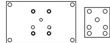
ALIGN HOLES IN GASKET AS SHOWN.
