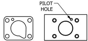
POSITION GASKET TO SEAL PILOT HOLE ON SIDE 'B' AS SHOWN.
