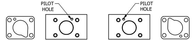
POSITION GASKET TO SEAL PILOT HOLE ON SIDE 'B' AS SHOWN.
