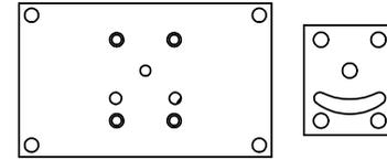
ALIGN HOLES IN GASKET AS SHOWN.
