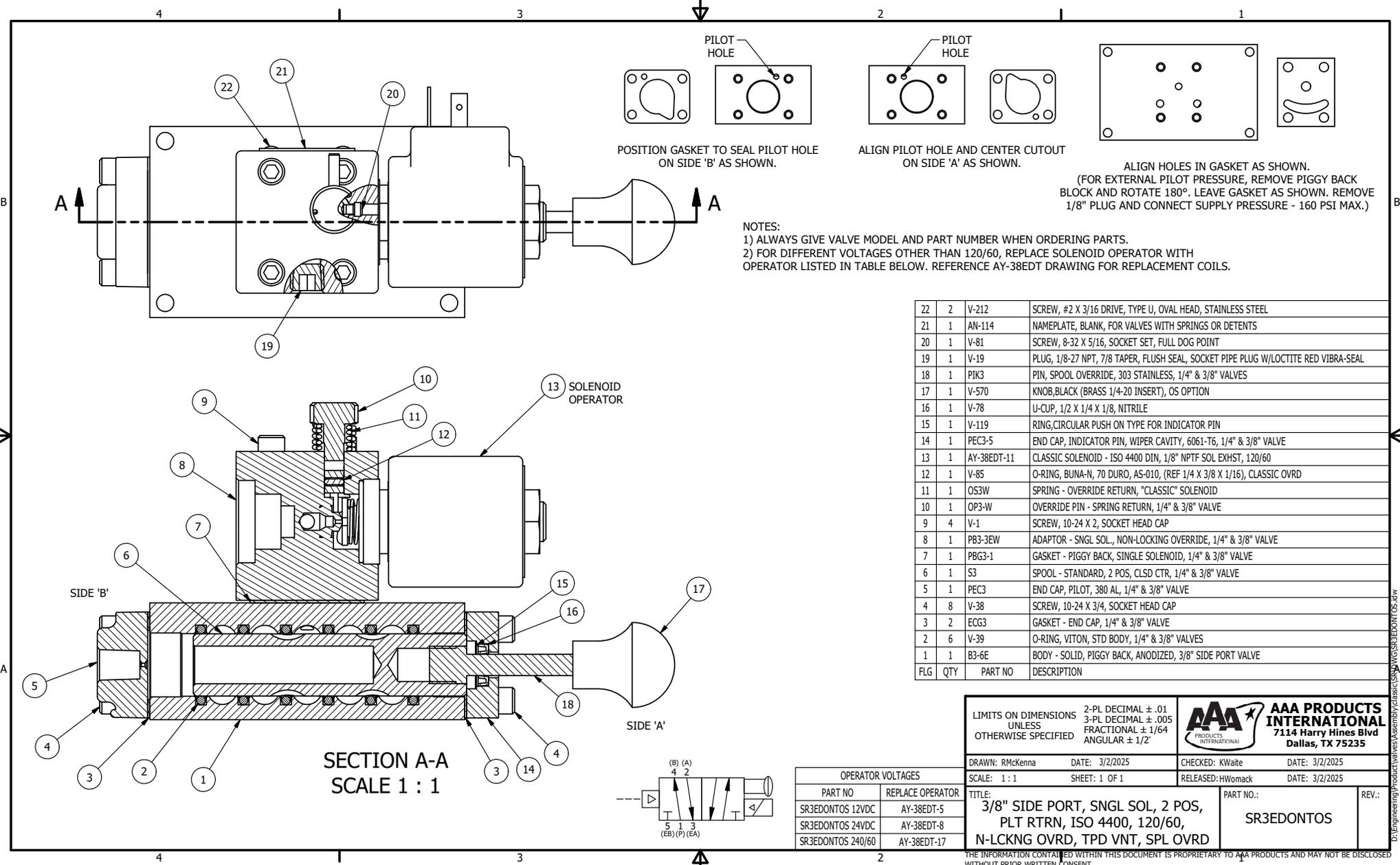
POSITION GASKET TO SEAL PILOT HOLE ON SIDE 'B' AS SHOWN.
