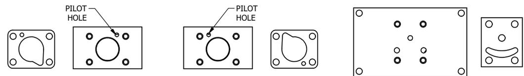
POSITION GASKET TO SEAL PILOT HOLE ON SIDE 'B' AS SHOWN.
