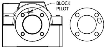
POSITION GASKET ON END OF VALVE SO GASKET COVERS PILOT HOLE, BOTH SIDES
